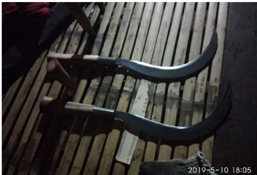
Celurit dengan Bahan Baja Hitam Sumber: Dokumentasi Agit Yogi Subandi
