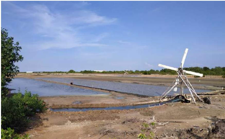
Kipas Penyedot Air untuk Memindahkan Air Sumber: Dokumentasi Agit Yogi Subandi
